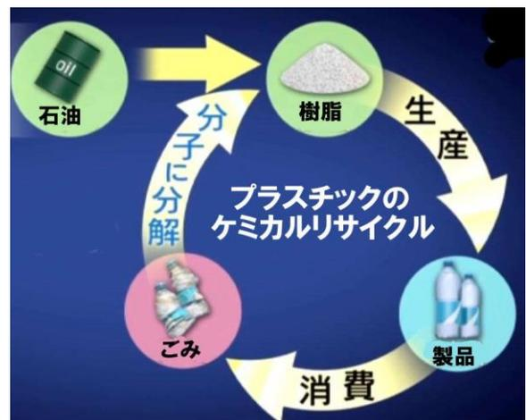
この技術を使えば石油の代わりにペットボトルを資源として長期間使用する事が出来る。同様に洋服に含まれている化学繊維も品質を落とさずに資源として再利用できるという。衣料品の約60%はポリエステル繊維が使用されており、衣料品に含まれるポリエステル繊維を溶かしだし、精製して、もう一度ポリエステル繊維の原料であるポリエステル樹脂を製造する技術開発にも成功している。
